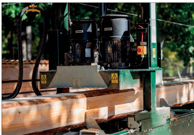
Za pohon pily Ecos gen slouží dva elektromotory; jeden disponuje výkonem 5,5, druhý 7,5 kW. K dokonalému upevnění dřeva slouží úchyty – dole
