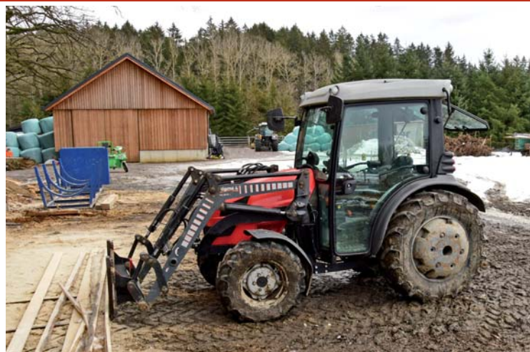
Pro manipulaci s materiálem využívají v Drážďanech u Častrova malotraktor SAME Solaris 45 s nakladačem Sigma 4 vybaveným vidlemi
