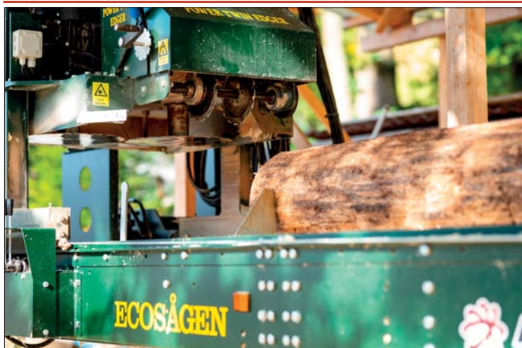
Na srovnání šířky zpracovávaného dřeva je určena sámovací jednotka Power Twin Edger
